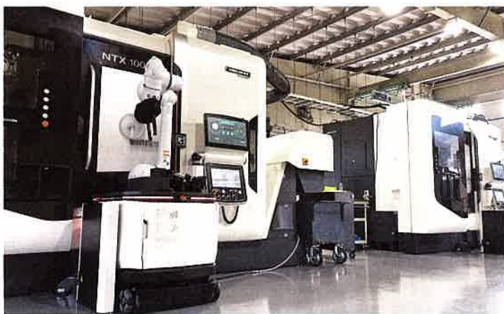
試験片加工を全自動化された最先端の生産システム。24時間稼働で効率化された分、社員の作業負担の軽減と生産能率の向上を両立させ、更なる事業拡大につなげています。
