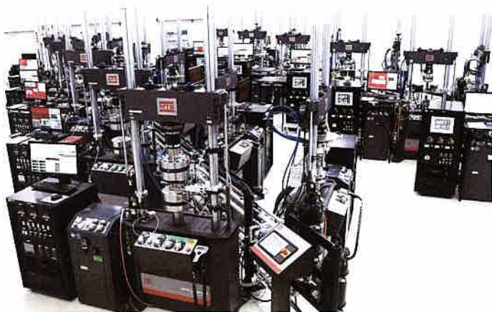
室温はもちろん低温や高温において試験片に引張や圧縮の荷重を繰り返しかけ、材料の耐久性(疲労強度)を取得しています。世界基準の試験ができる疲労試験機の所有台数は国内最大級です。
