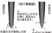
先端の刃が摩耗した時 わずかにR(曲線)をもたせ この角から抵抗になり、 ることで刃先強度を上げ、 切りづらく感じます。 刃欠けしにくくなります。
