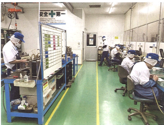
製作した金型を約700面保管しており、定期的にメンテナンス(分解・清掃)を実施。
